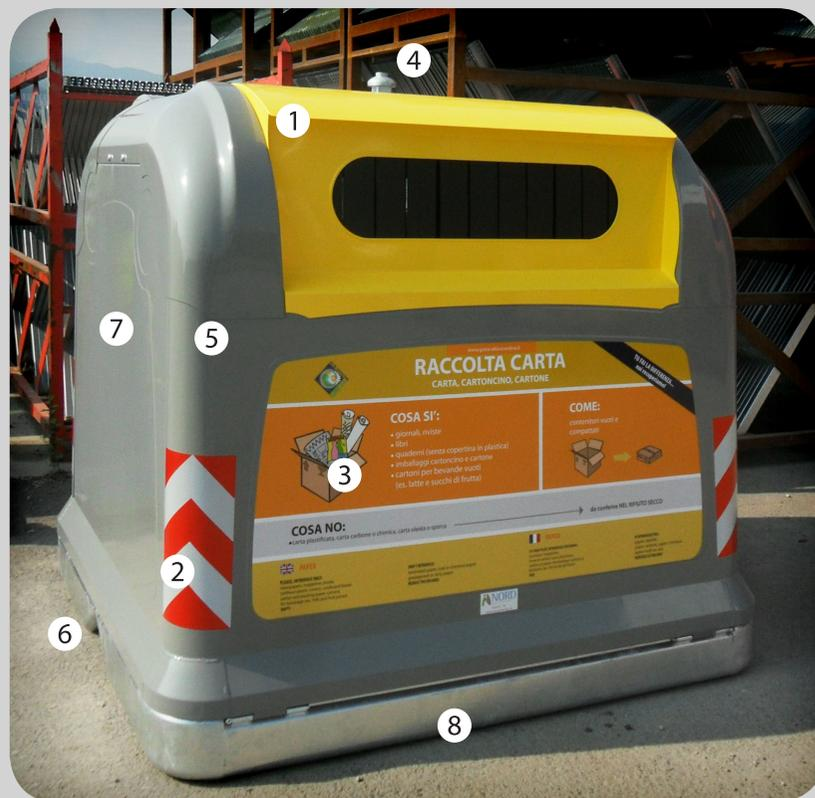
**Características principales:** lámina de acero con tratamiento antioxidante y con pintura epoxi (1), tiras luminosas sobre cada borde (2), la indicación del tipo de residuo (3), ancla de expansión F90 (4), bordes redondeados (5), apertura triangular que permite instalar una guía de acero para mantener el contenedor alineado (6), estructura de acero galvanizada, pintura sintética (7), base de acero galvanizado: altura 150mm, capacidad: de 120 a 150 litros según el modelo (8).
